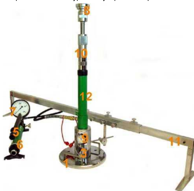
Rys. 1.2 Aparatura VSS z jednopunktowym pomiarem przemieszczenia płyty
